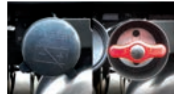
배터리 컷오프 스위치 장기 주차 시 배터리 방전 방지 및 편의성 증대
