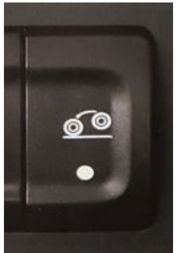
트랙션 헬퍼기능 6×2 트랙터 구동축에 하중을 부여하여 미끄러운 노면으로부터 탈출 용이
